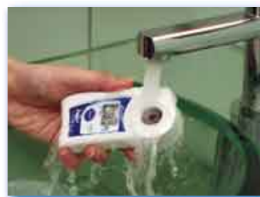
可用自來水沖洗鏡台 (嚴禁浸泡水中)
